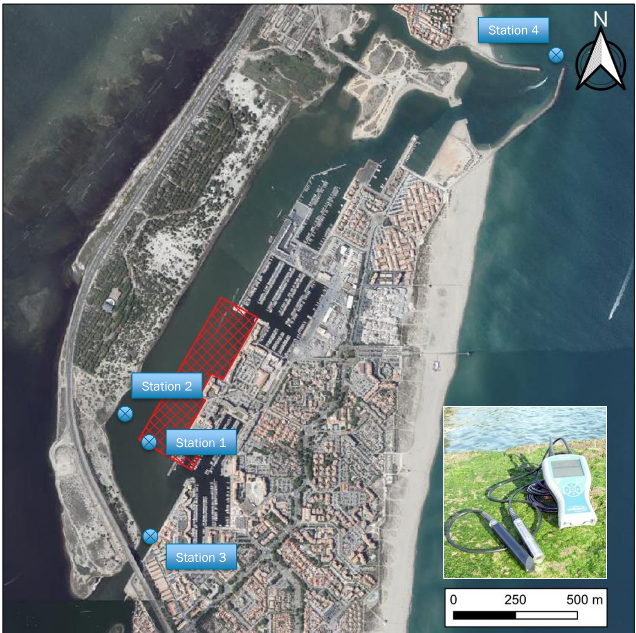
Figure 13 : Localisation des stations de suivi de la turbidité – Les stations 1 et 2 sont déplacées au fur et à mesure de la progression des travaux. Exemple de sonde turbidimètre pour mesurer in-situ la turbidité de l'eau.
