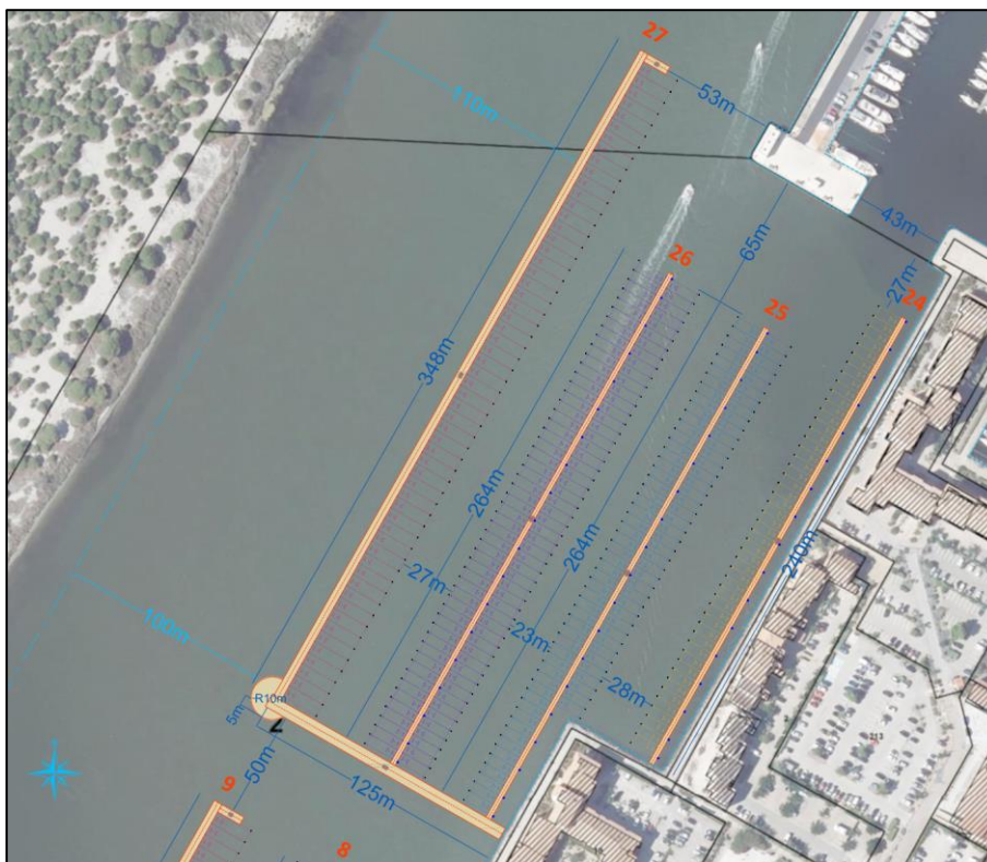
Figure 4 : 2 ème tranche des travaux, avec la finalisation du belvédère et l'ajout de 300 postes d'amarrage
