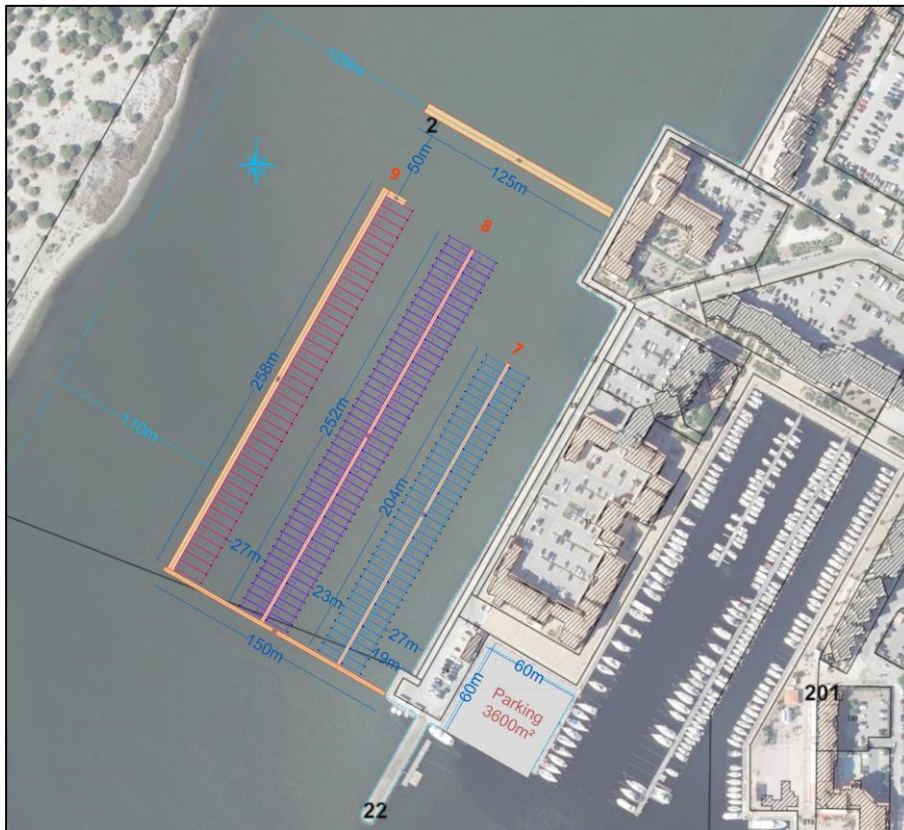
Figure 3 : 1 ère phase des travaux, apportant 222 postes d'amarrage et 203 places de parking
